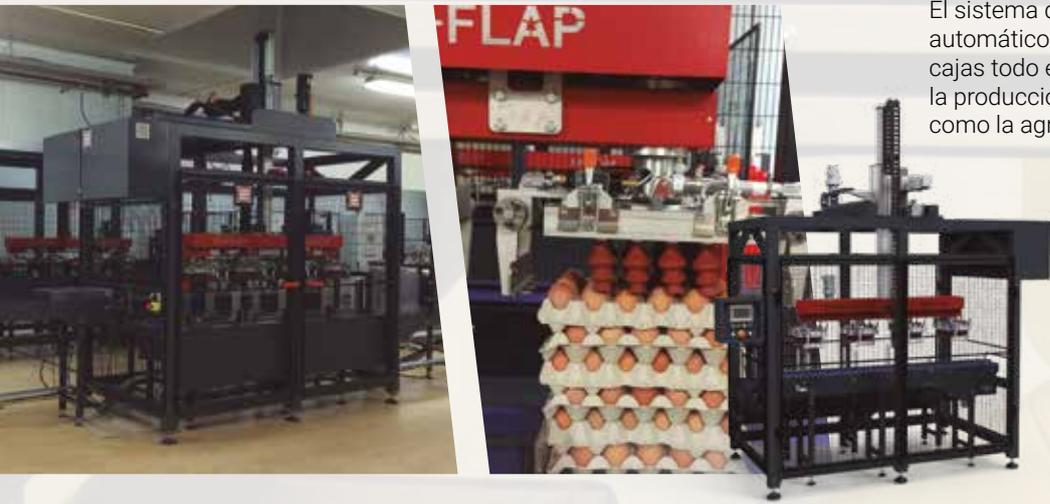
El sistema de Pick & Place combina el armado automático de cajas, el encajado y el cerrado de cajas todo en uno. Adaptamos el encajado según la producción, el tipo de producto o envase, así como la agrupación o posición dentro de la carga.
