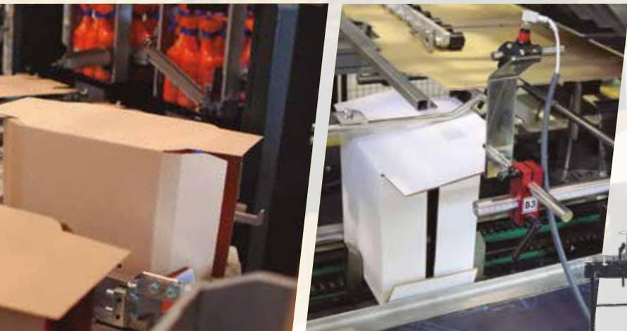
Encajadoras Wrap Around para producciones de 10 hasta 25 cajas/minuto. Según el producto o envase, puede ser de encajado lateral o superior.
